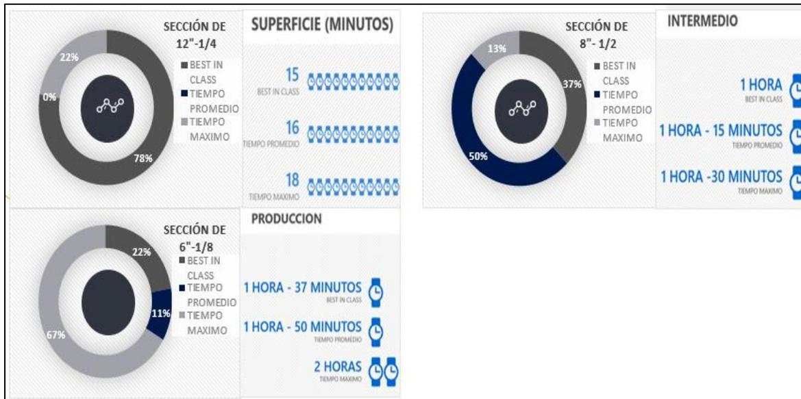
*Nota:* La figura 42 muestra los infogramas y los diagramas de 360° que describen los tiempos determinados y como se encuentra la operación actualmente en cada sección, respecto al tiempo circulando en la operación de corrida de revestimiento.
