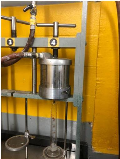
*Nota: La figura evidencia el momento en el que se registraban los ml obtenidos de la prueba de filtrado API del fluido con 1 ppm de nano-grafito.*
