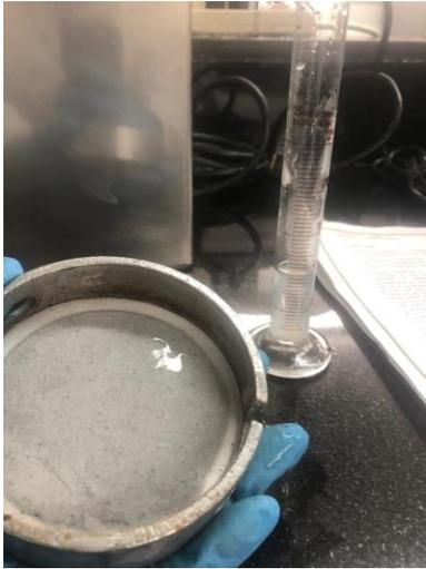
*Nota: La figura evidencia el cake y el filtrado obtenido en la prueba de filtración API del lodo base.*
