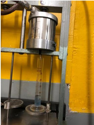
*Nota: La figura evidencia el momento en el que se registraban los ml obtenidos de la prueba de filtración API del fluido con 1 ppm de nano-sílice.*
