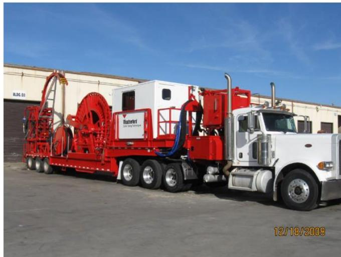
**Nota:** La figura representa la unidad de Coiled Tubing 38 fabricada por NOV HYDRA RIG, perteneciente a Weatherford Colombia. Tomado De: Nov Hydra Rig, *Owner's Manual W/Photos For Tractor Wet Kit & Trailer Ctu Weatherford.*, Fort Worth, Texas, 2009.
