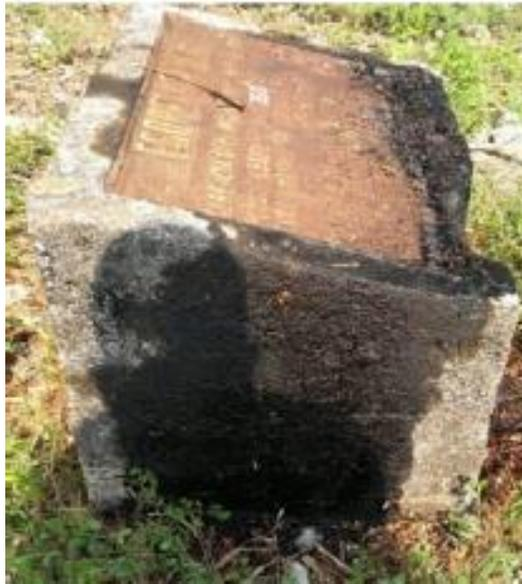
**Nota:** se muestra presencia de hidrocarburos en la lápida lo cual indica una posible filtración en los tapones de abandono: ECOPETROL, *Formato para la Justificación de Intervención de Pozo Casabe-350, Bogotá D.C.*
