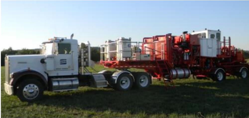
**Nota:** la figura como es la unidad de bombeo de WEATHERFORD para la inyección de fluidos en el pozo tomado de: N WEATHERFORD, Unidad Bombeo- tipo doble.
