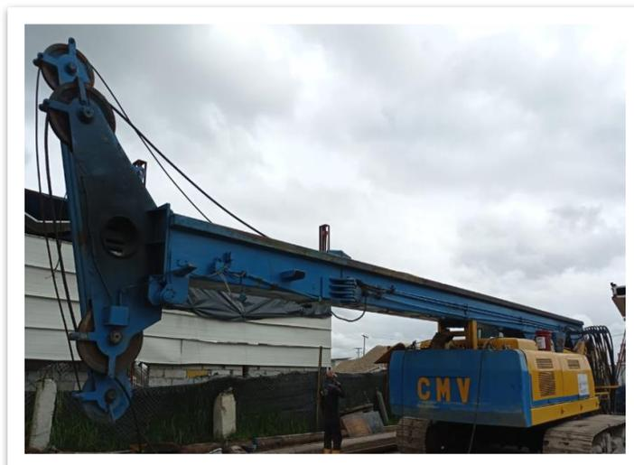
**Nota.** Pieza mástil y bloque de poleas de la maquina piloteadora.
