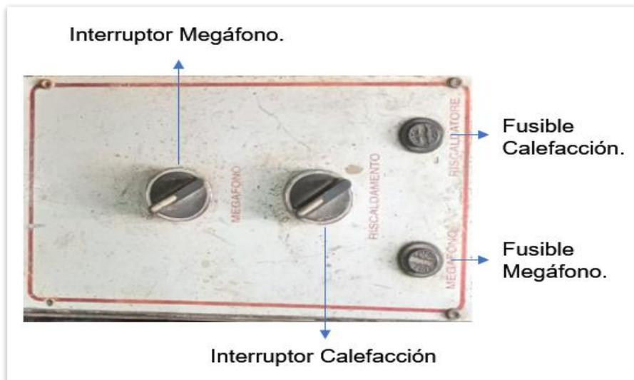
**Nota.** Se muestra las acciones que contiene el panel de servicios de la maquina piloteadora.
