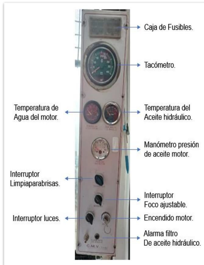
**Nota.** La imagen describe los diferentes instrumentos que componen o integran el panel de control.
