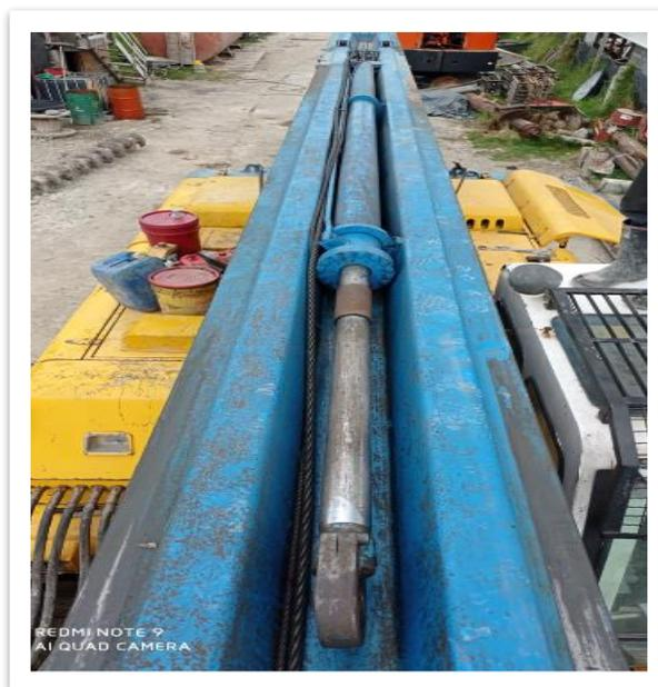
**Nota.** Pieza Pull-Down de la maquina piloteadora.
