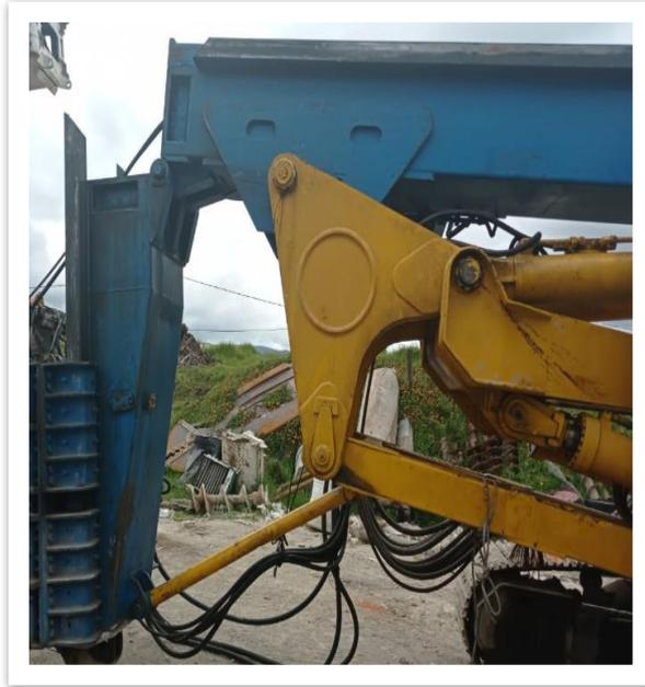
**Nota.** En la imagen se muestra el pantógrafo de la maquina piloteadora armado.
