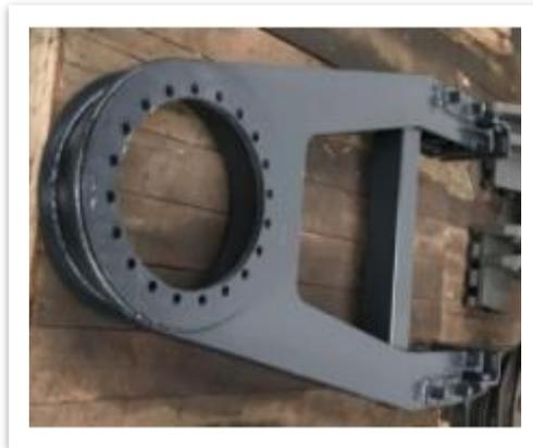
**Nota.** La imagen describe los extremos de la barra Kelly de la máquina. Tomada de: Drilling tools <http://www.bjunidrill.com/en/product/Parts-for-rigs.html> [Acceso: 20 de agosto de 2020]
