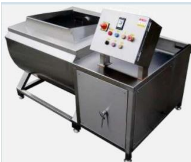
Ilustración 27. Lavadora para alimentos con capacidad de 20 a 40 kg por carga
