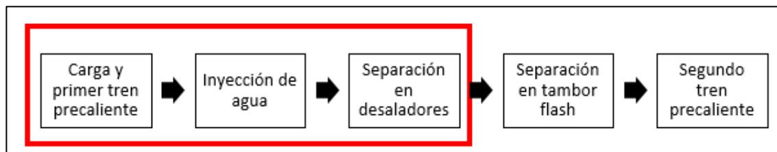
Diagrama 7. Etapas relevantes para el desalado de crudo
