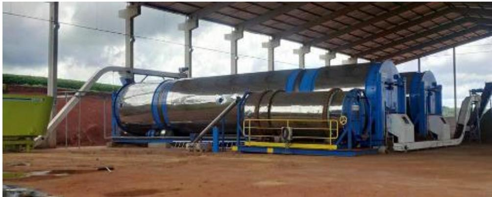
Fuente: XACTSYSTEMSCOMPOSTING. Reactor horizontal para compostaje. [En línea]. Recuperado en 2019-10-17. Disponible en: <https://xactsystemscomposting.com/wp-content/uploads/2015/04/Composting-equipment.jpg1>
