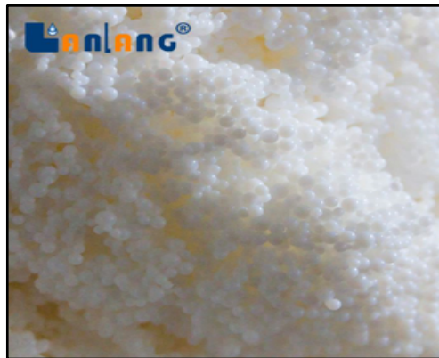
Ilustración 28. Esferas de resina sin ser activada con NaOH.
