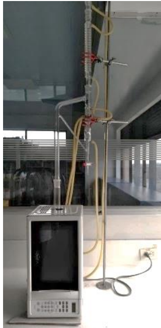
Ilustración 9. Extracción de hidrodestilación asistida con microondas a nivel laboratorio.
