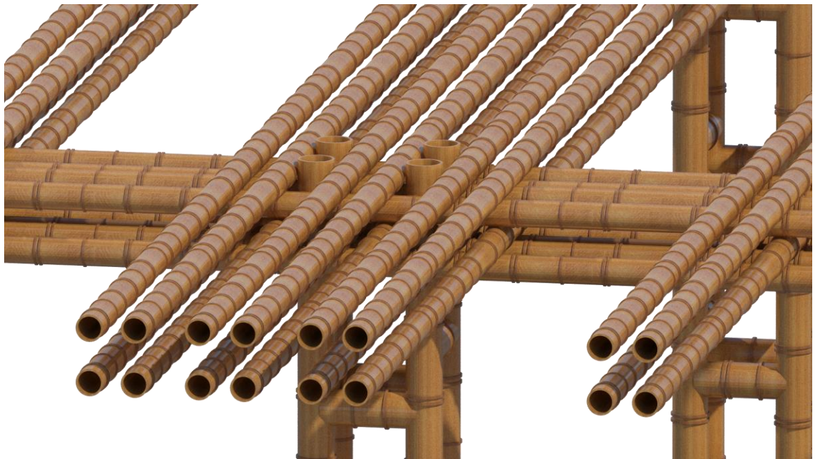
Imagen 58. Detalle unión columna viga de entre piso
