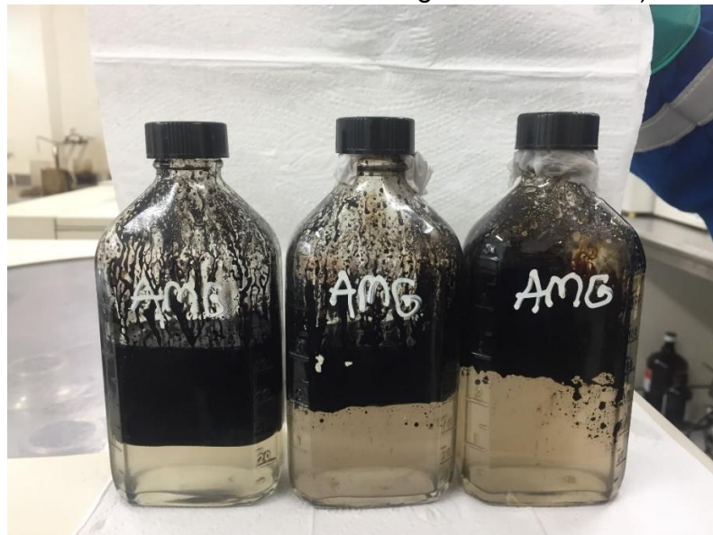
Imagen 1. Muestras patrón (crudo troncal CLB2 + tratamiento reductor de viscosidad + agua troncal CLB2)
