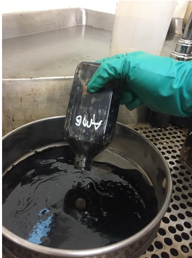
Imagen 2. Filtración del fluido de las botellas
