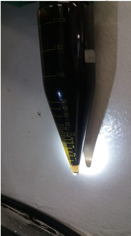
Imagen 4. Determinación del BSW inicial por método de la centrifuga
