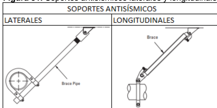
Figura 31. Soportes antisísmicos laterales y longitudinales.
