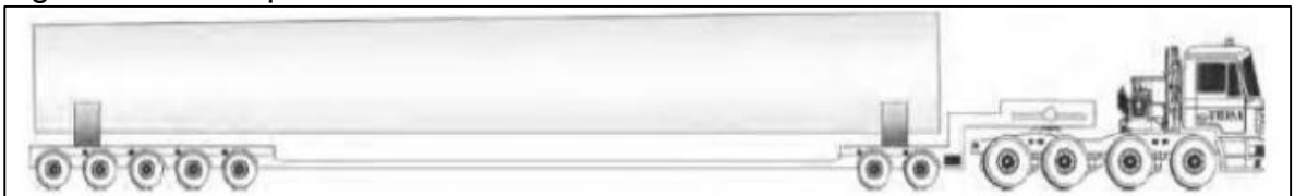
Figura 115 Transporte del tramo 2 de la torre
