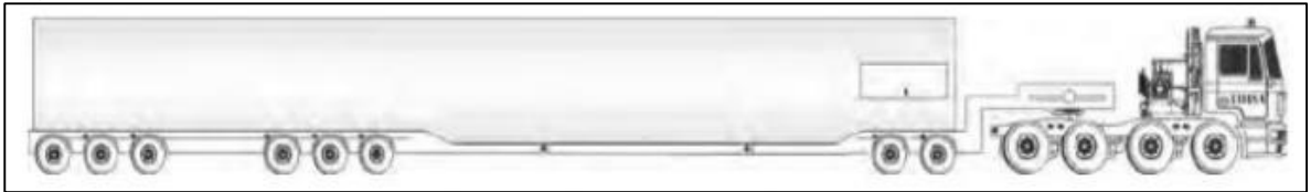
Figura 114 Transporte del tramo 1 de la torre
