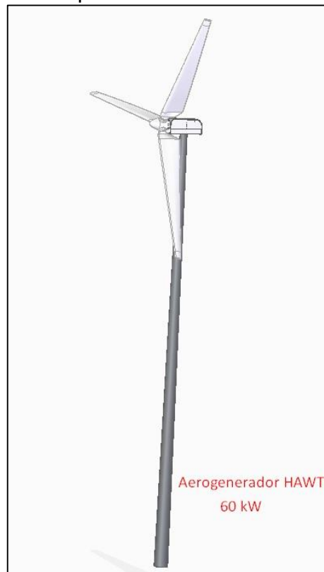
Figura 146 Aerogenerador de 60 kW de potencia
