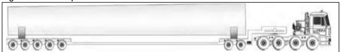
Figura 117 Transporte del tramo 3 de la torre
