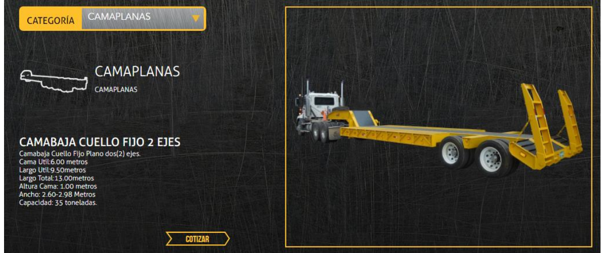
Figura 120 Cama Baja para Tramo 4 de la torre
