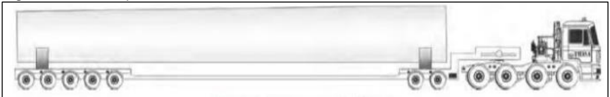
Figura 119 Transporte del tramo 4 de la torre
