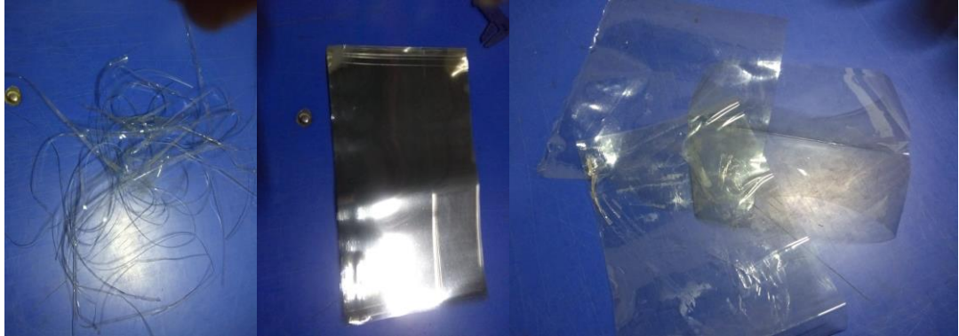
Figura 15. Tramos y laminas que no cumplen con la calidad
