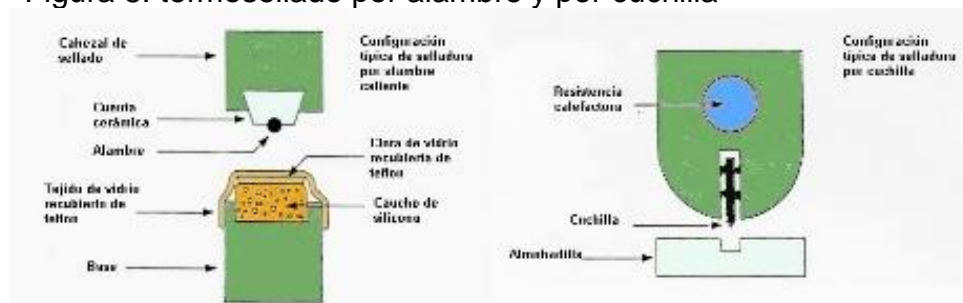
Figura 8. termosellado por alambre y por cuchilla
