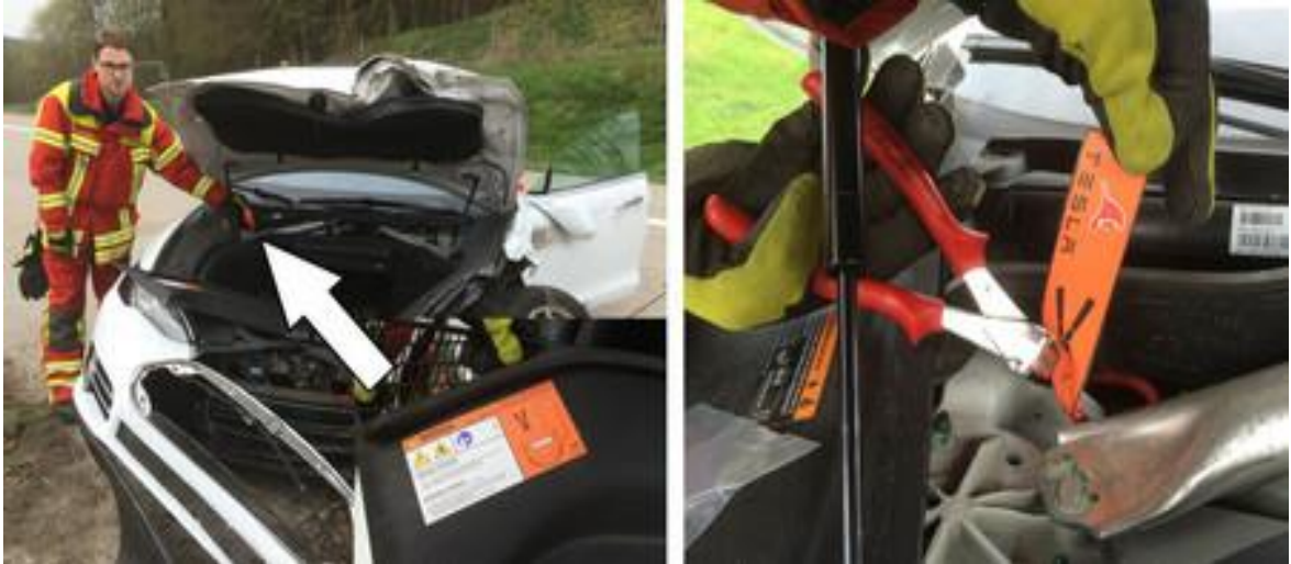
Figura 61. Identificación de cables de desenergización
