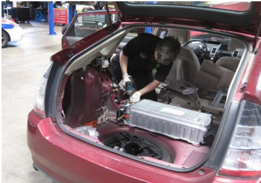
Figura 51. Desmonte de banco de baterías
