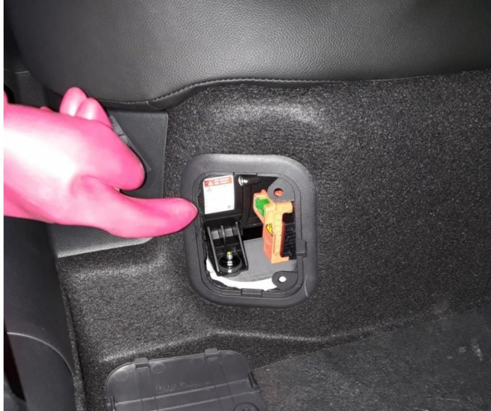
Figura 47. Conector de seguridad de un Kia Niro
