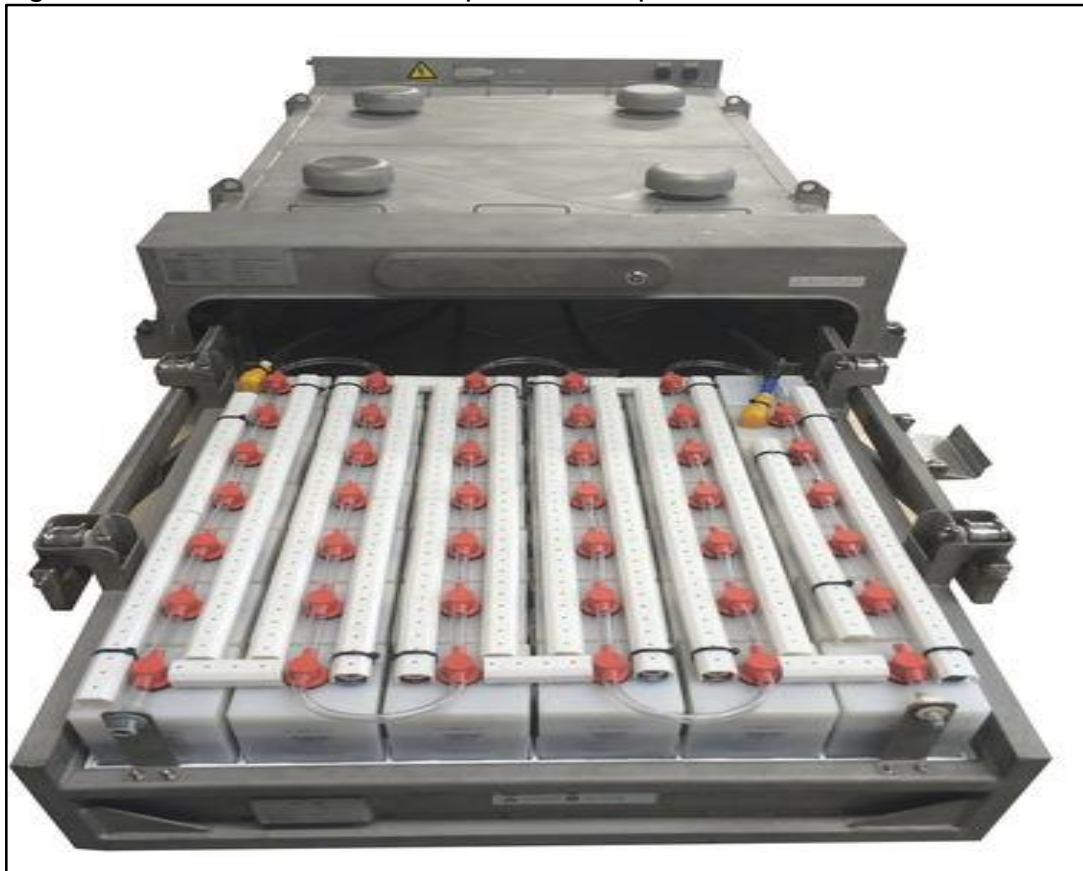
Figura 15. Banco de baterías Níquel-cadmio para vehículos
