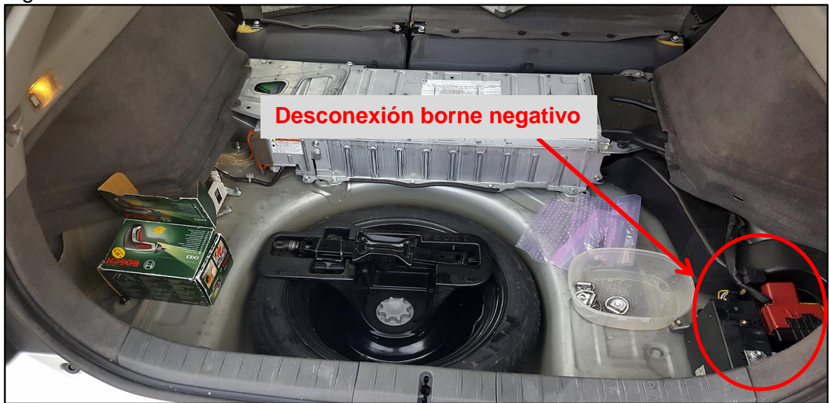
Figura 46. Desconexión de batería convencional
