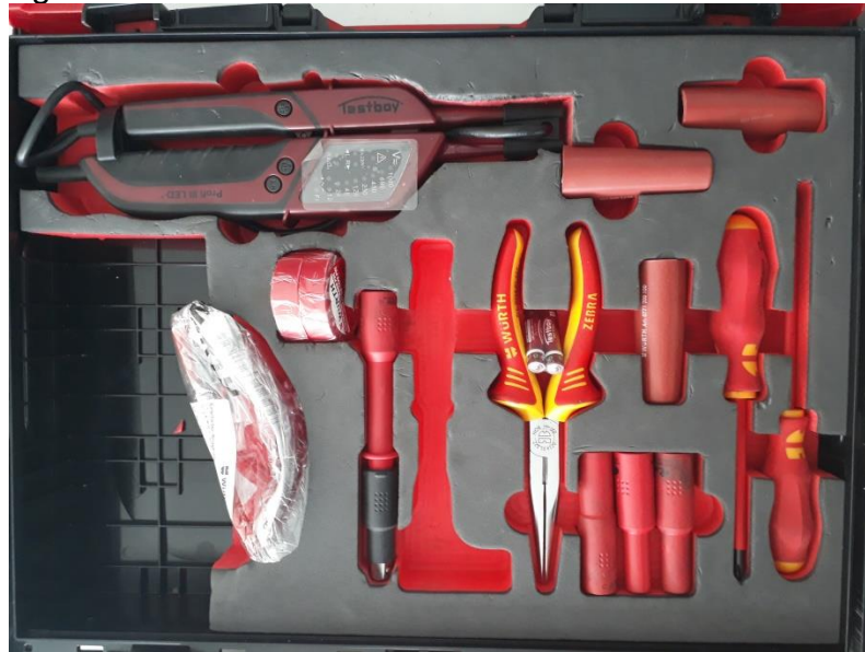
Figura 39. Herramientas con aislantes eléctricos
