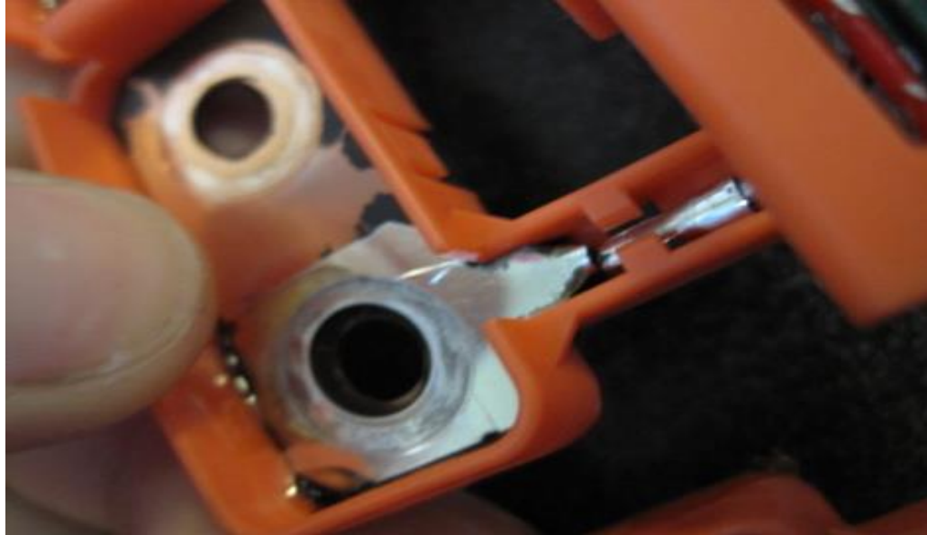
Figura 50. Fractura de cable de alto voltaje
