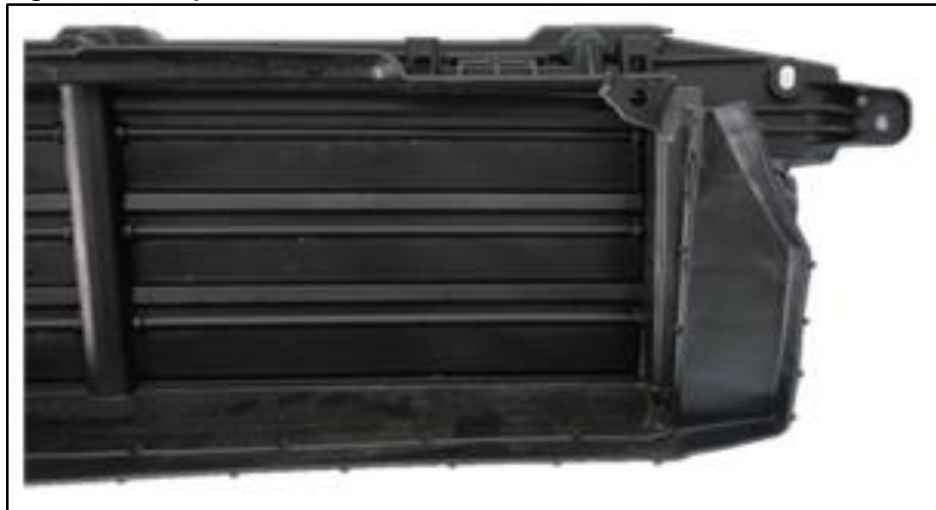
Figura 93. Rejillas eléctricas de ventilación
