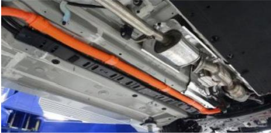
Figura 40. Cables de alta tensión aislados de un Hyundai Ioniq
