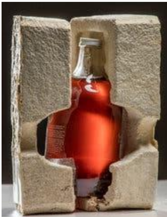
Imagen 33. Material de embalaje que fue fabricado por Ecovative con un tipo de hongo
