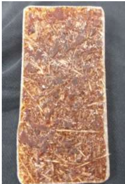
Figura 21. Material compuesto degradado al ser expuesto a mezclas de biocombustible
