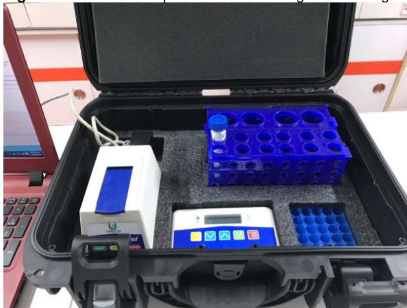
Figura 53. Luminómetro para medición de carga microbiológica.
