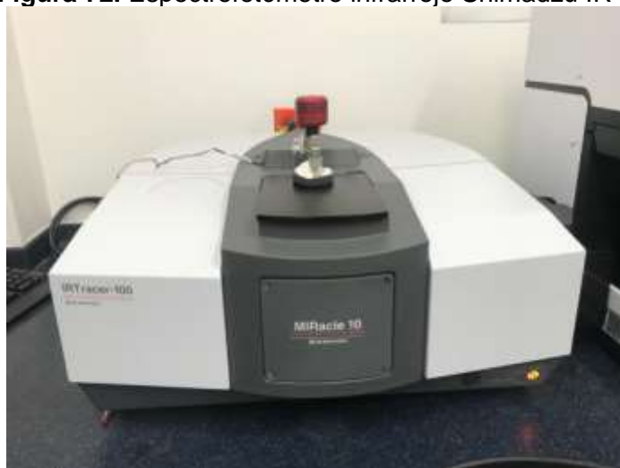
Figura 72. Espectrofotómetro infrarrojo Shimadzu IR Tracer-100
