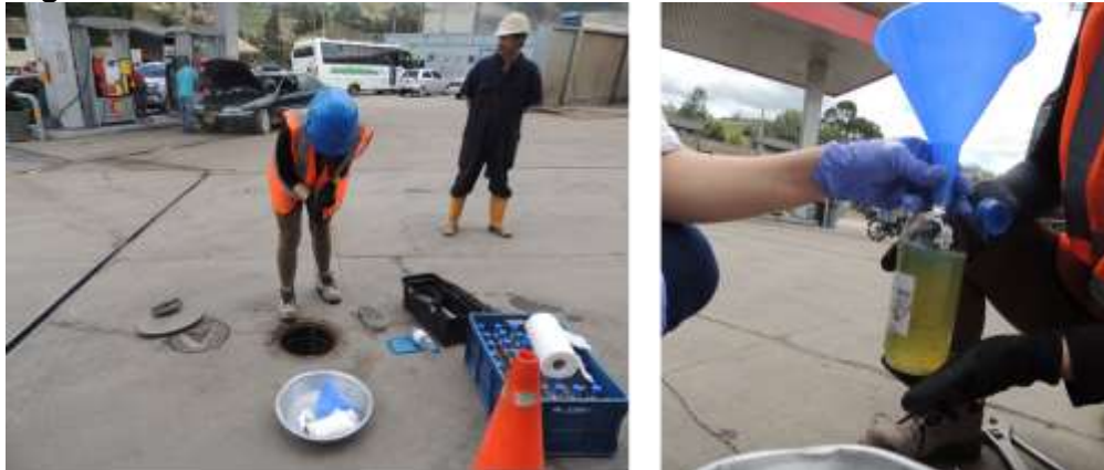
Figura 24. Toma de muestras de combustible diésel
