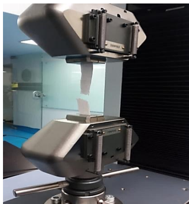
Figura 21. Rompimiento de probeta 70/30 en maquina Universal
