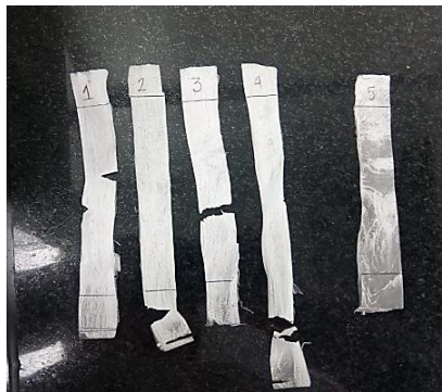
Figura 20. Prueba de tensión para muestras de P3HB/PLA (50/50)
