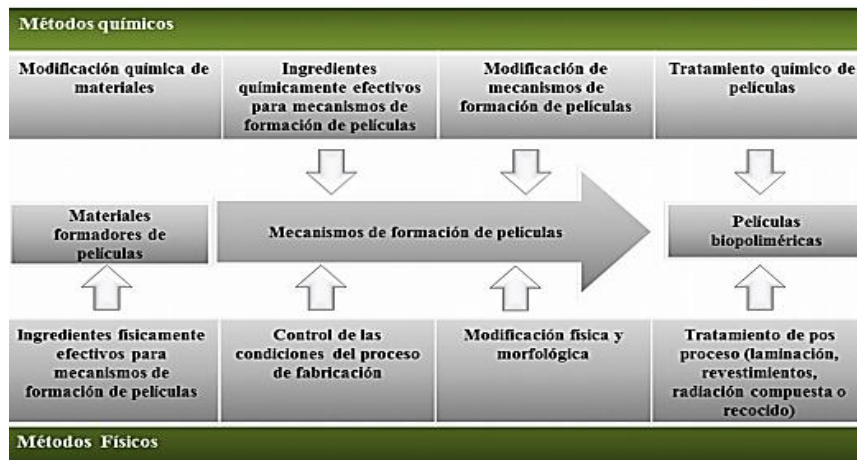
Figura 5. Mecanismos para la formación de películas poliméricas.
