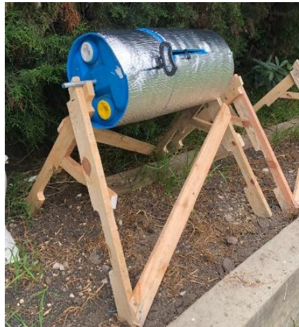
Imagen 4. Reactor con aislante térmico y soporte
