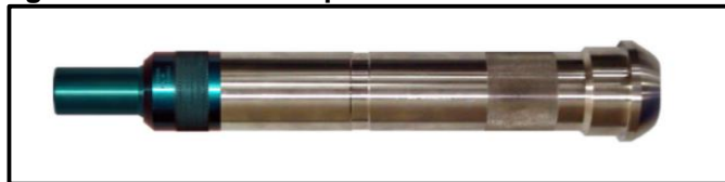
Figura 16. Bulkhead de presión.
