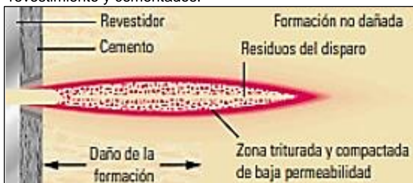
Figura 6. Cañoneo en pozos completados con revestimiento y cementados.
