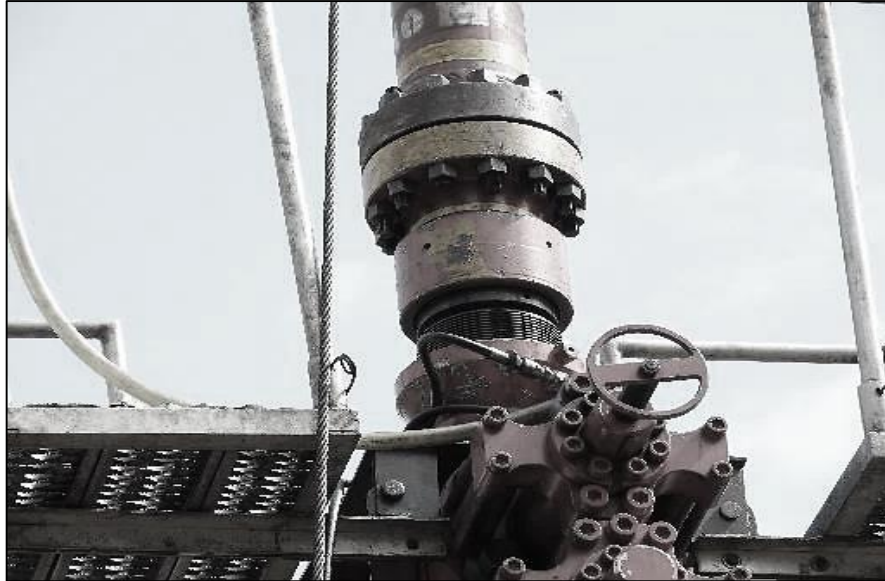
Figura 57. Conexión lubricador CT con sub de prueba rápida.
