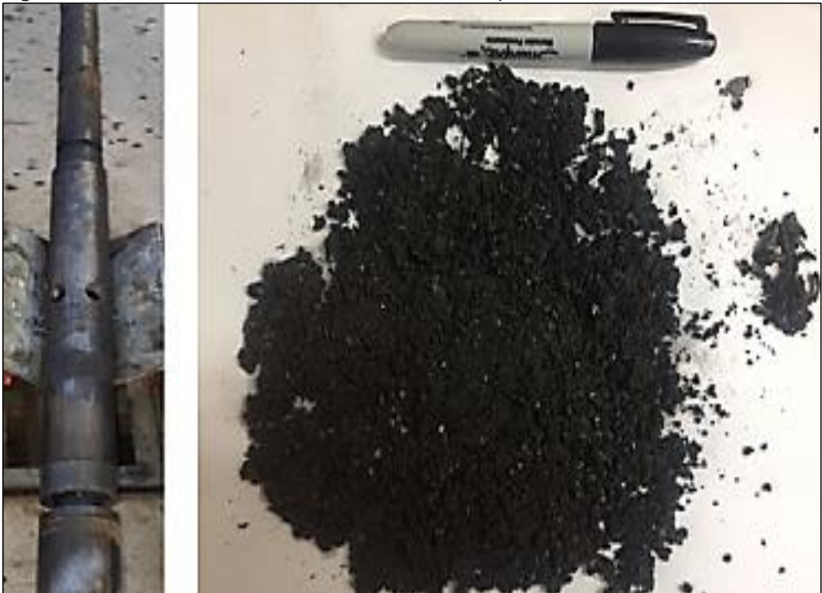
Figura 58. Material encontrado en la cámara de vacío posterior al cañoneo.
