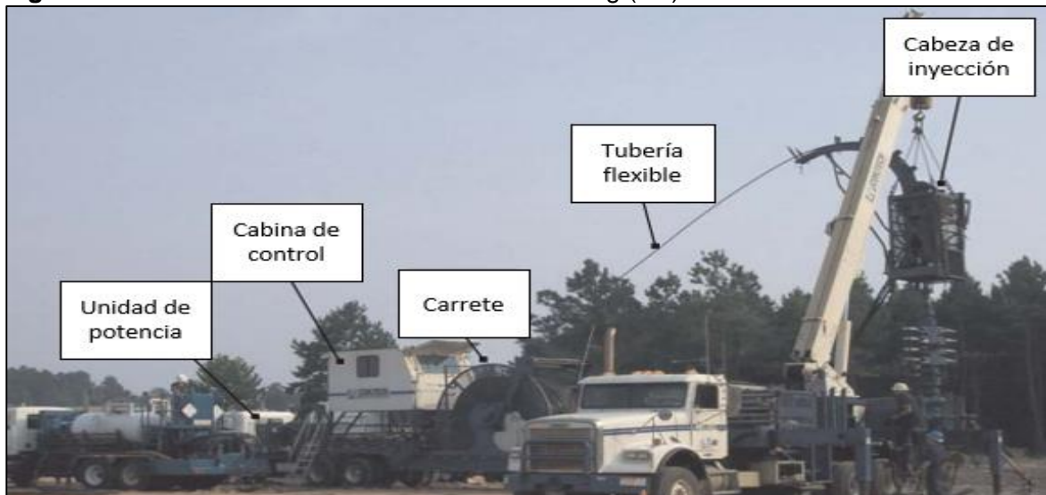
Figura 27. Unidad de tubería flexible o Coiled Tubing (CT).
