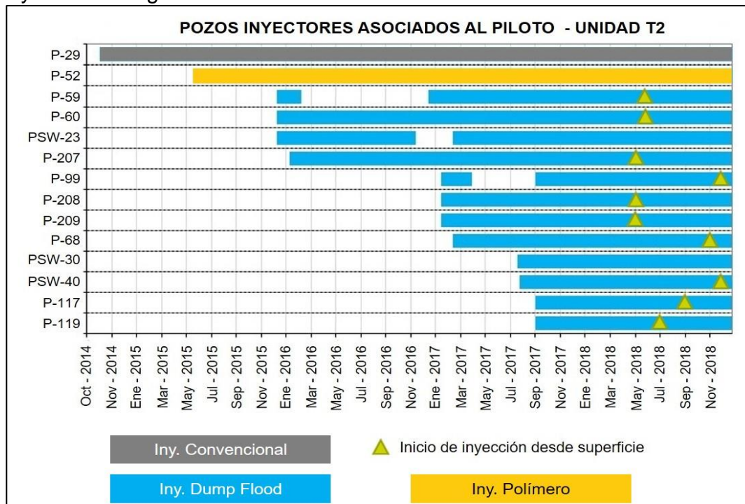
Figura 106. Línea de tiempo de los pozos inyectoros asociados al piloto de inyección de agua.
