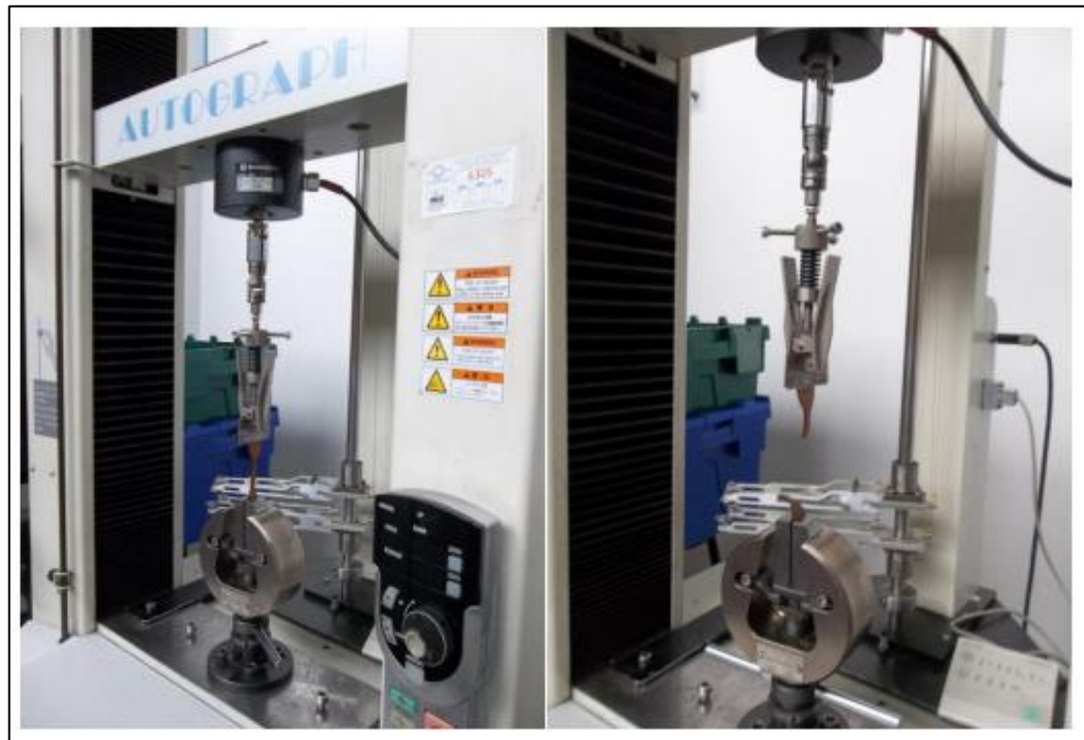
Figura 20. Izquierda: Instalación de la Probeta. Derecha: Probeta ensayada
