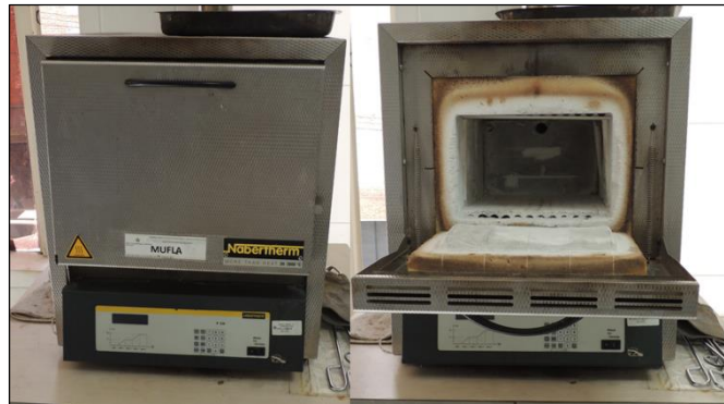
Imagen 4. Horno de secado para la eliminación de agua de la pasta del residuo
