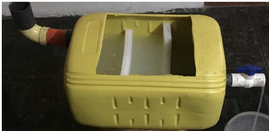
Figura 25. Funcionamiento de la trampa de grasas experimental.
