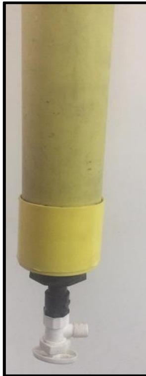
Figura 38. Filtro de carbón activado
