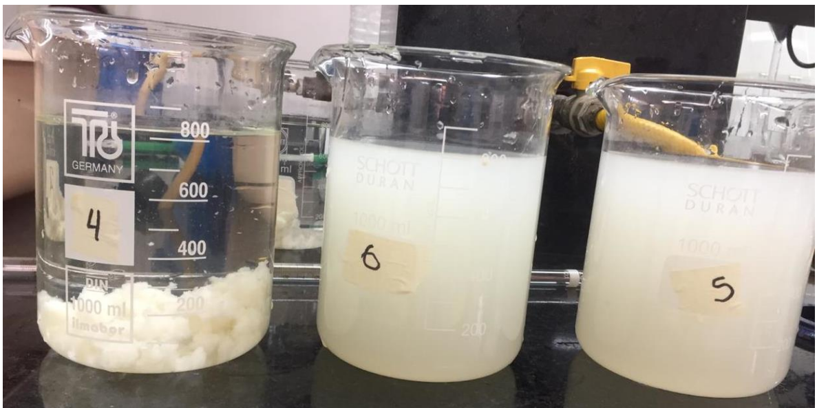
Figura 31. Test de jarras 3: Evaluación del policloruro de aluminio
