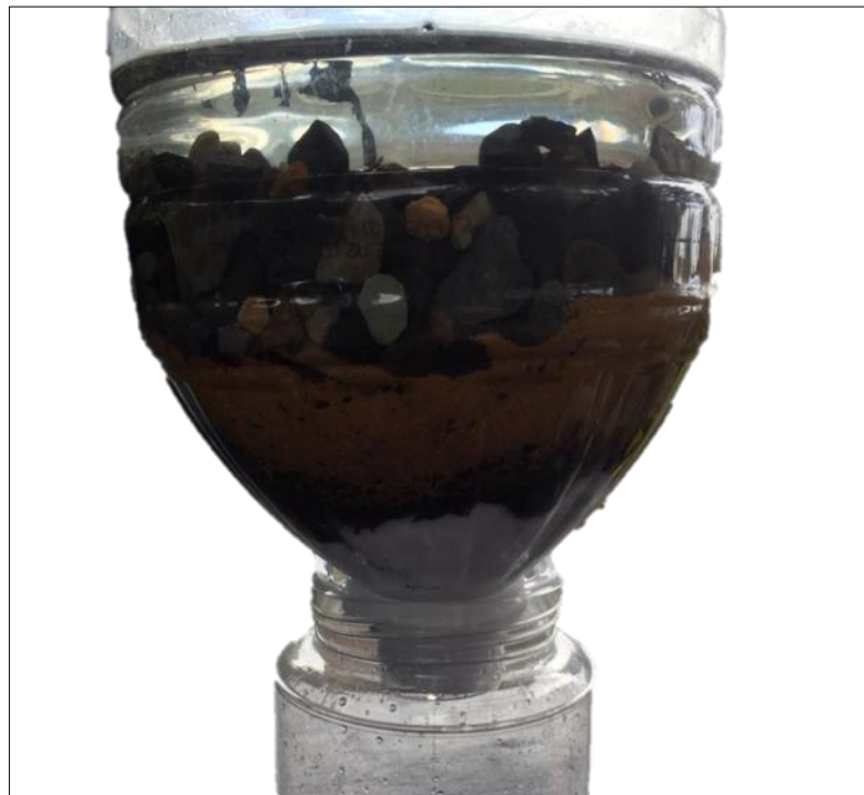
Figura 33. Filtro natural con carbón activado, arena, grava y algodón
