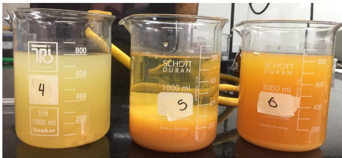
Figura 30. Test de jarras 2: Evaluación del cloruro férrico
