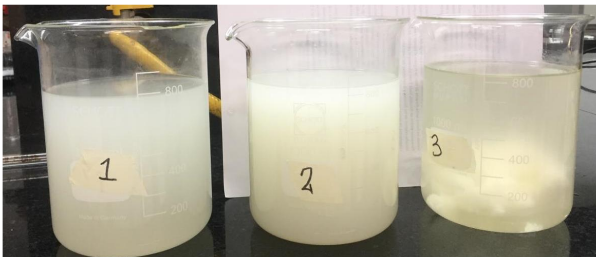
Figura 29. Test de jarras 1: Determinación del floculante
