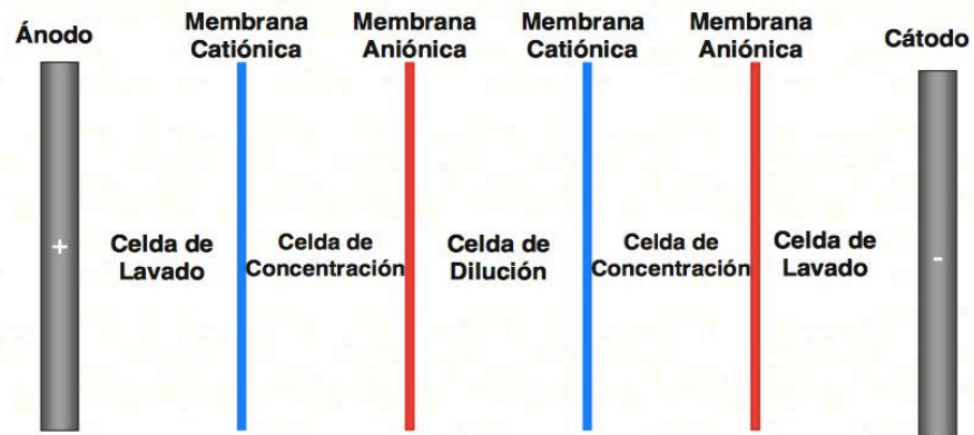
Ilustración 13. Celdas de la unidad de electrodesionización
