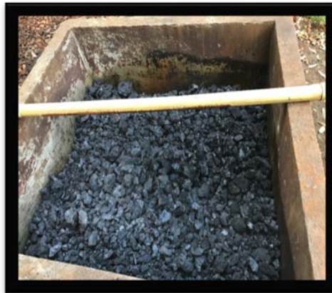
Ilustración 19. Tanque de adsorción con carbón
