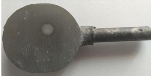
Figura 13. Muestra de acero por medio del muestreador CELOX.
