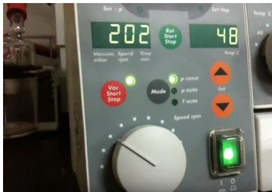
Imagen 5. Controladores del roto evaporador
