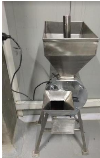
Fotografía 14. Molino, encargado de la molienda en la microcervecería Dope D.C.
