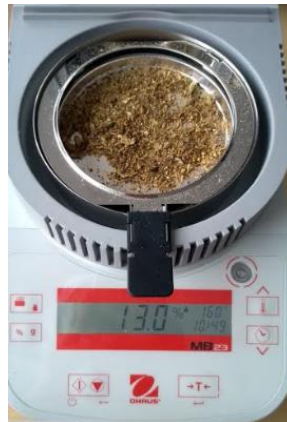
Fotografía 8. Imagen del valor de la humedad arrojado por el MB23 para la malta pale ale.
