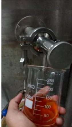
Fotografía 17. Toma de muestra en la etapa de fermentación para determinar su FG.
