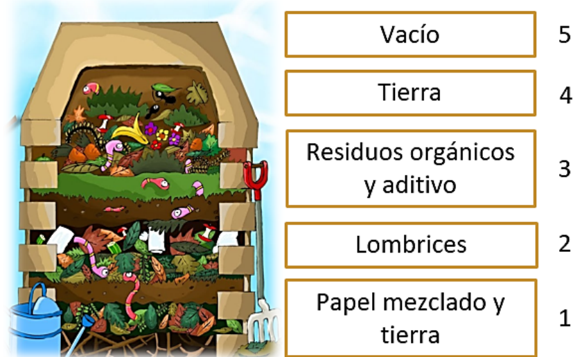
Figura 7. Montaje del contenido de la compostera.
