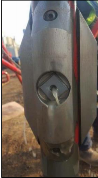
Figura 22. Vista en superficie de la herramienta de Sand Jetting.
