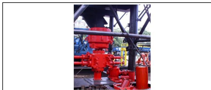
Figura 3. BOP de un equipo de Workover
