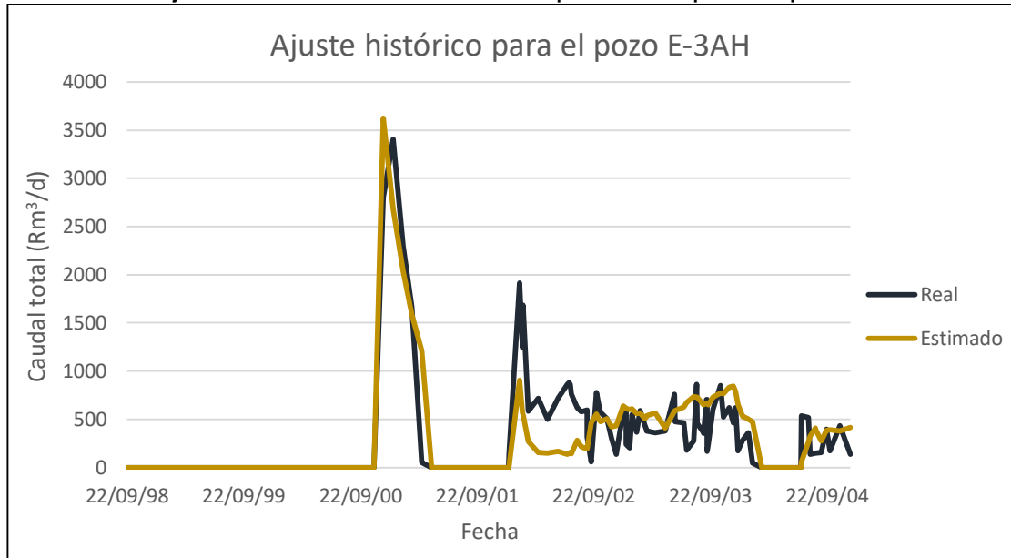
Gráfica 9. Ajuste histórico de caudal total producido para el pozo E-3AH
