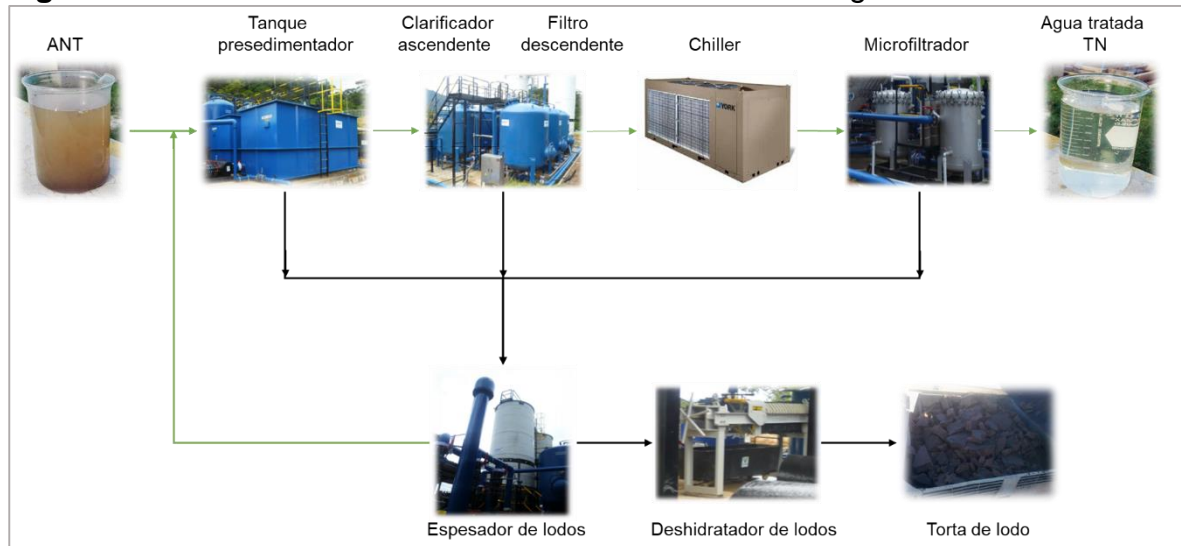
Figura 18. Proceso del sistema de tratamiento nuevo del agua.
