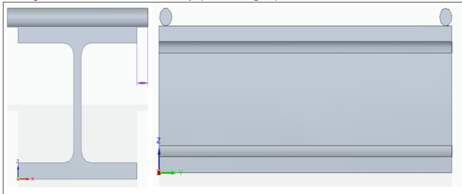
Imagen 20. Vistas frontal y perfil viga pasador
