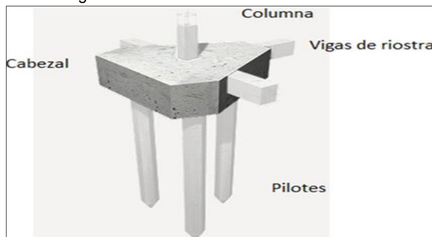
Imagen 4. Dado de cimentación
