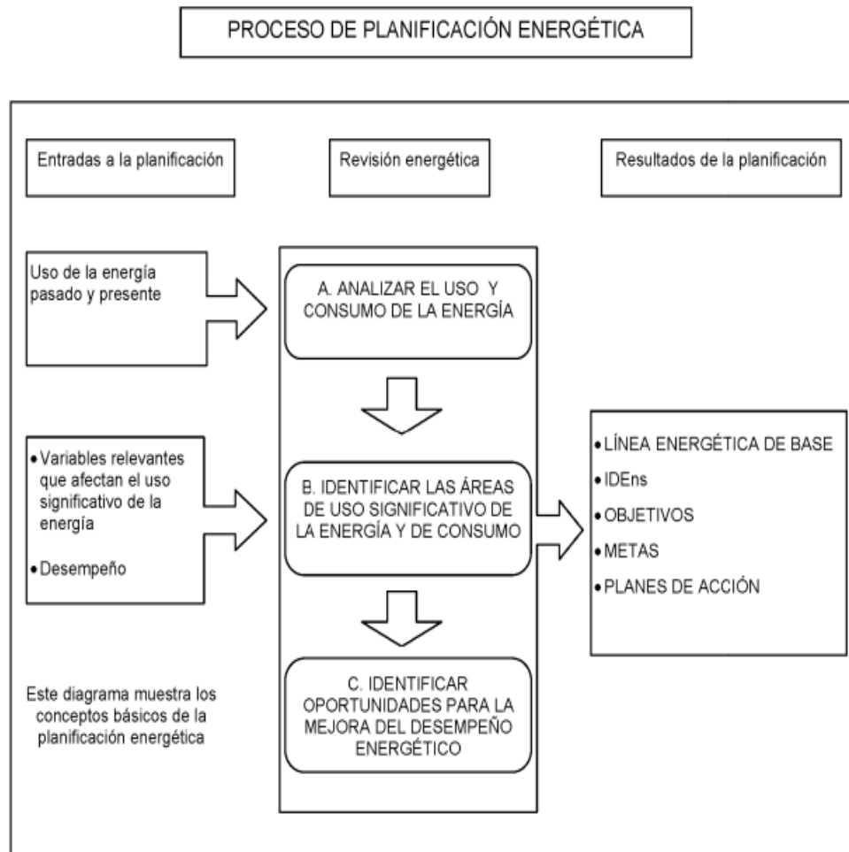
Figura 2. Diagrama conceptual del proceso de planificación energética.
