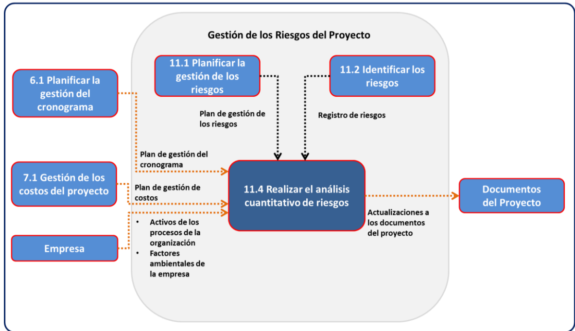
Ilustración 41 Diagrama de flujo de datos de realizar el análisis cuantitativo de riesgos
