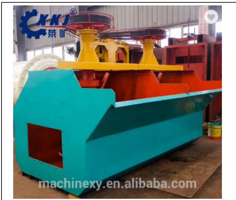
Cuadro 4. Celda de flotación BF-10
