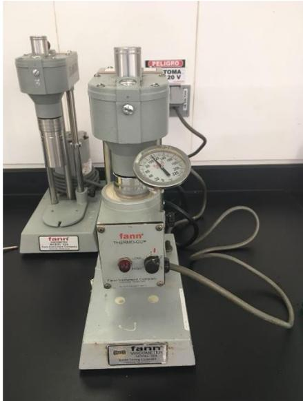
En la **Figura 8** se presenta el equipo utilizado para la prueba de reología en donde se aprecian algunos de sus componentes como el rotor, el contenedor y el termómetro.
