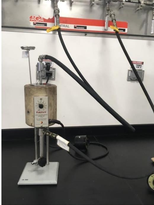
**4.2.6 Prueba PPT.** El objetivo de la prueba PPT es determinar el funcionamiento de la nanobentonita como obturante en un medio permeable. Esta prueba se realizó a condiciones de 180°F de temperatura y 1000 psi de diferencial de presión, con un disco de 35  $\mu\text{m}$  el cual sirve de referencia para evaluar Campo Castilla. El resultado de esta prueba se expresa como se observa en la **Ecuación 5**
