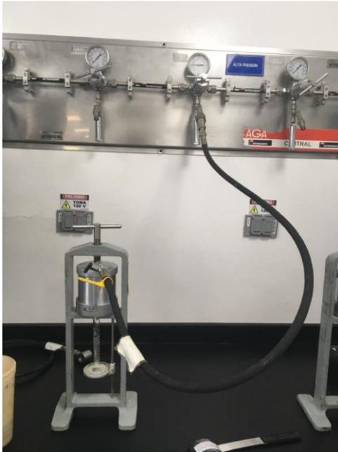
Dentro de los componentes del equipo mostrado en la **Figura 9** se encuentra una probeta utilizada para recolectar el filtrado resultante, así como el montaje realizado para alcanzar la presión de 100 psi.
