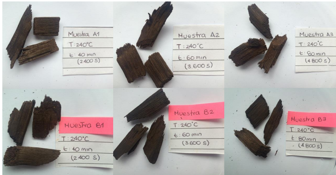
Figura 27. Biomasa torrefactada a 240°C durante 40 min (izquierda), 60 min (mitad) y 80 min (derecha) junto con su réplica (color rosado)
