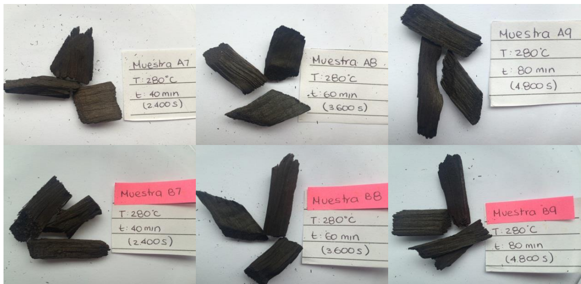
Figura 29. Biomasa torrefactada a 280°C durante 40 min (izquierda), 60 min (mitad) y 80 min (derecha) junto con su réplica (color rosado)
