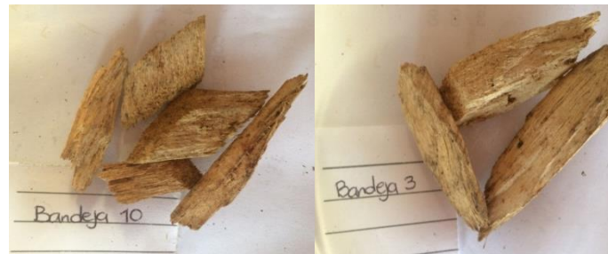
Figura 8. Tamaños de partícula identificados: bandeja 10 (trozos medianos, izquierda), bandeja 3 (trozos grandes, derecha)
