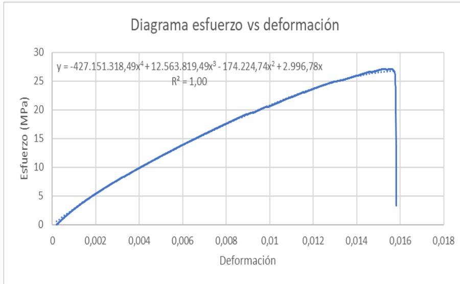
**Nota.** Gráfico de esfuerzo deformación del ensayo completo hasta la ruptura de la probeta.
