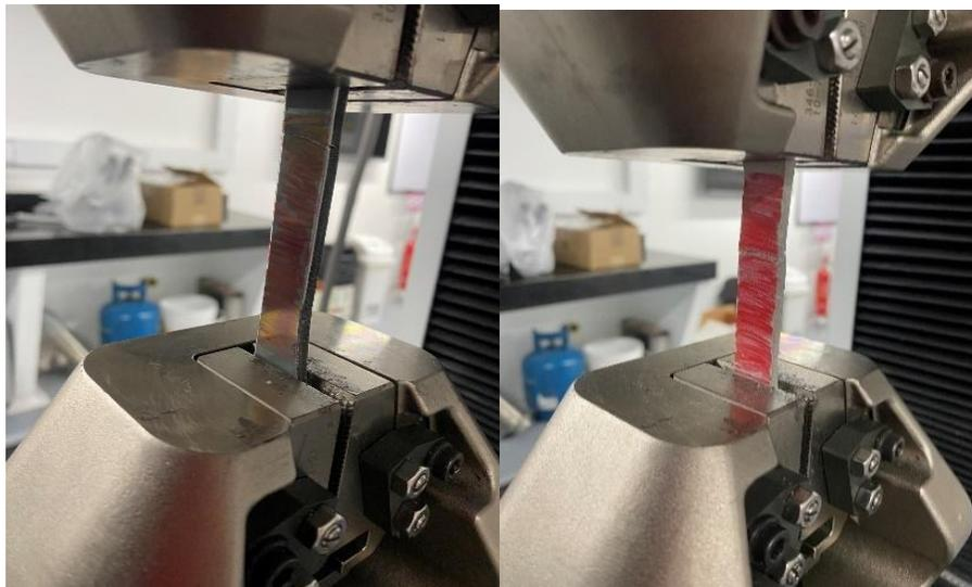
**Nota.** Fotografías Probetas montadas en el equipo mientras se realizaba el ensayo tanto de Alucobond como de fibra de vidrio.
