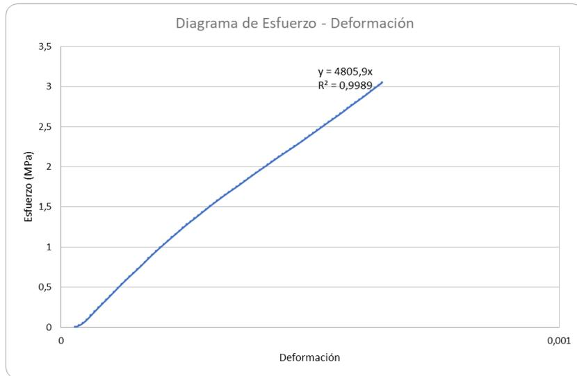
**Nota.** Gráfico de esfuerzo deformación de la zona elástica del material.
