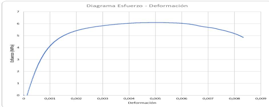
**Nota.** Gráfico de esfuerzo deformación del ensayo completo hasta la ruptura de la probeta
