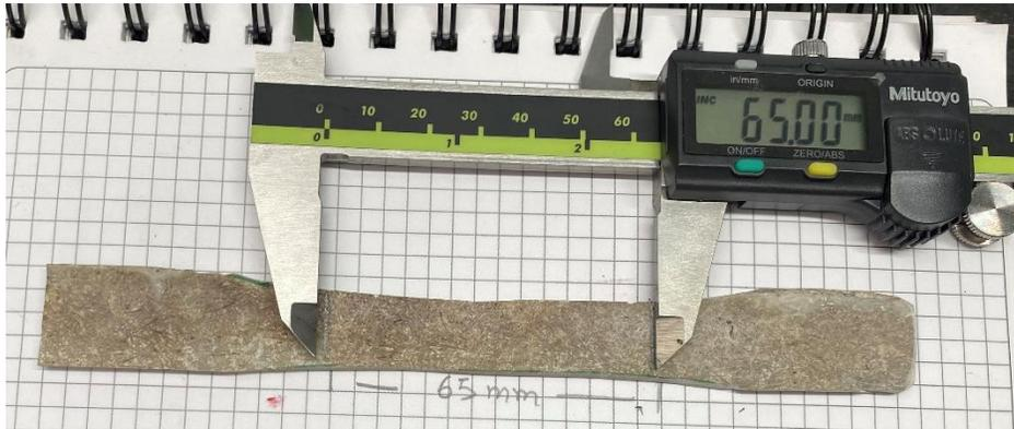
**Nota.** Toma de medidas de las probetas con pie de rey digital
