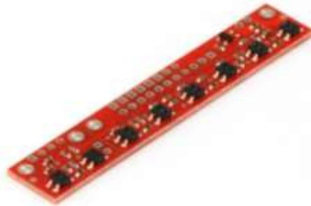
**Nota.** Imagen del sensor de línea (QTR-8A) – Arreglo análogo de (8). Tomado de: [ja-bots.com/producto](http://ja-bots.com/producto).
