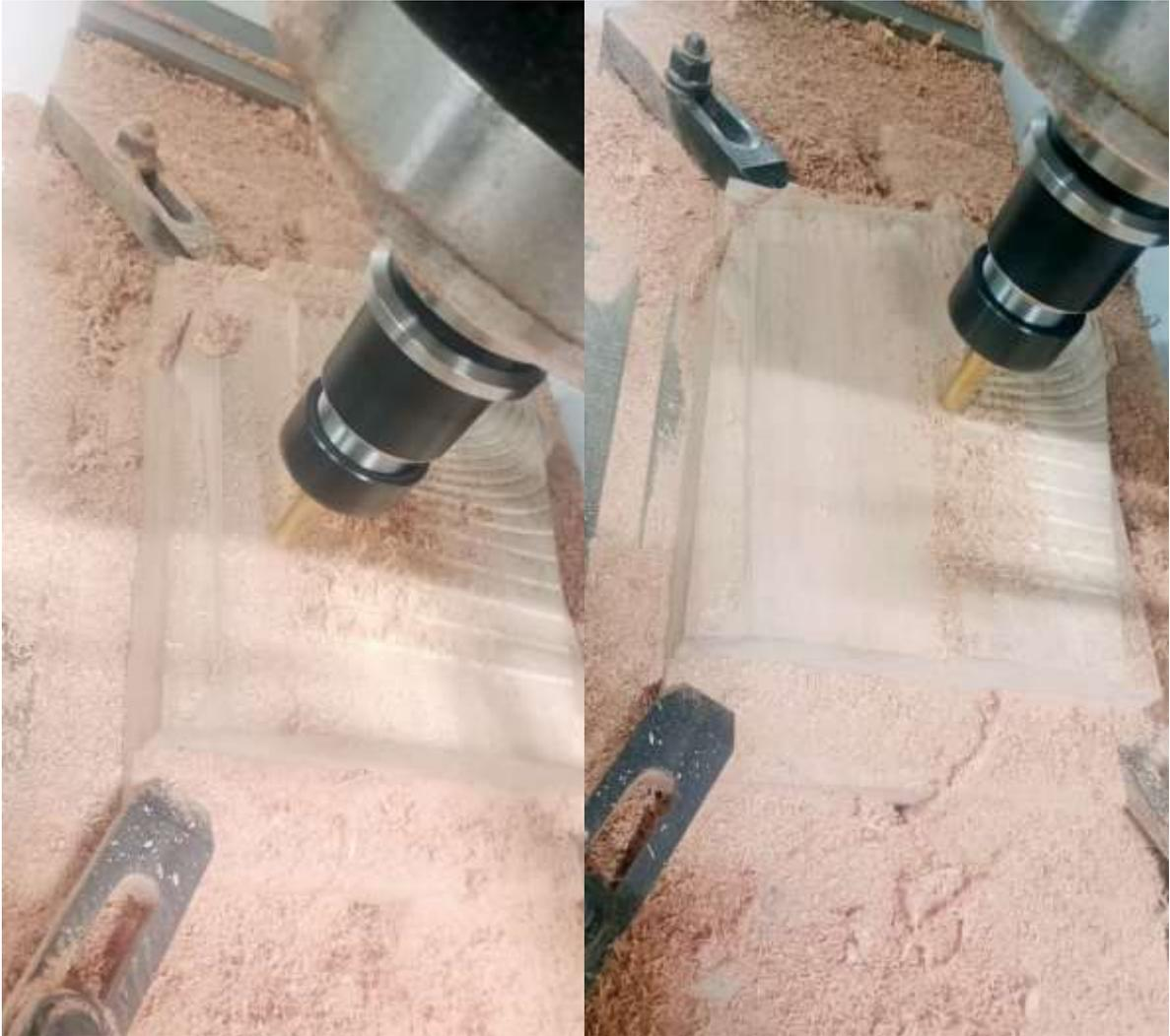
**Nota.** *Bloque de madera en el segundo proceso de modelamiento en el cual se quería detallar el acabado suave y curvo de la superficie para la conformación del molde final.*
