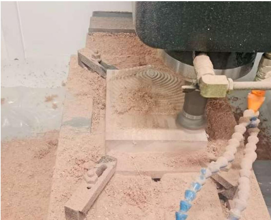
**Nota.** *Bloque de madera en el primer proceso de modelamiento en el cual se quería retirar la mayoría del material innecesario para la conformación del molde final.*
