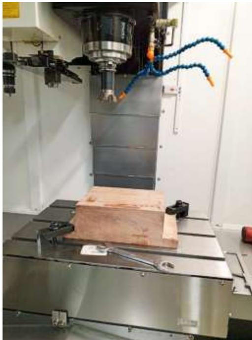
**Nota.** *Imagen del bloque de madera montado en la maquina CNC.*
