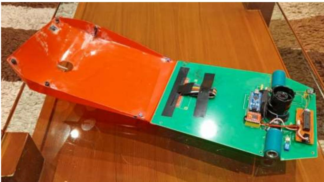
**Nota.** Prototipo final del robot velocista con la carrocería abierta.
