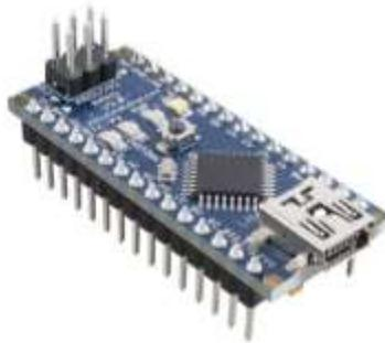
**Nota.** *Imagen del Arduino Nano V3.0. Tomado de: [ja-bots.com/producto](http://ja-bots.com/producto).*
