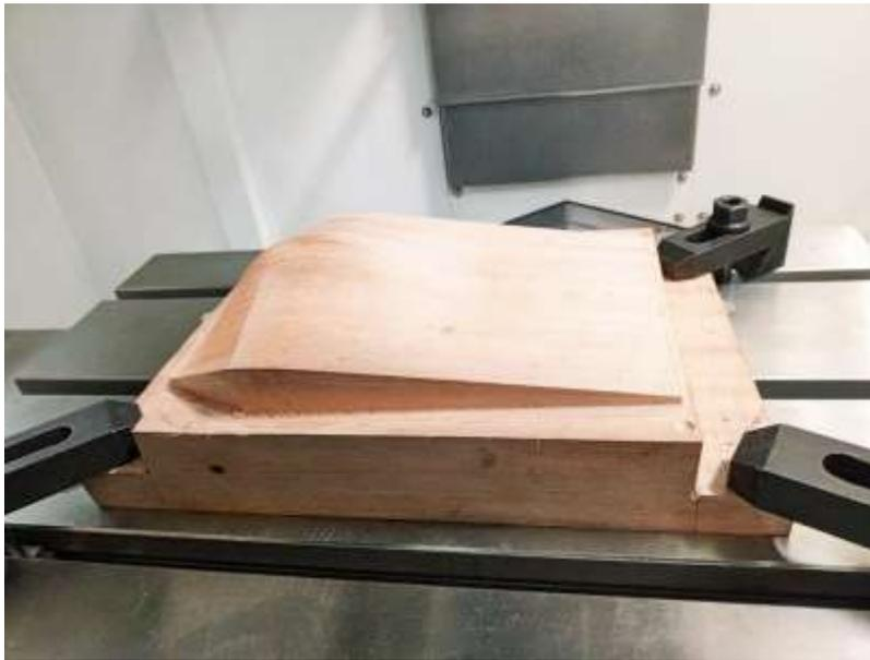
**Nota.** Molde de madera listo para el proceso final de rectificación y detallado a mano.
