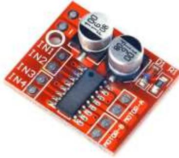
**Nota.** Imagen del mini controlador puente H L298. Tomado de: [ja-bots.com/producto](http://ja-bots.com/producto).
