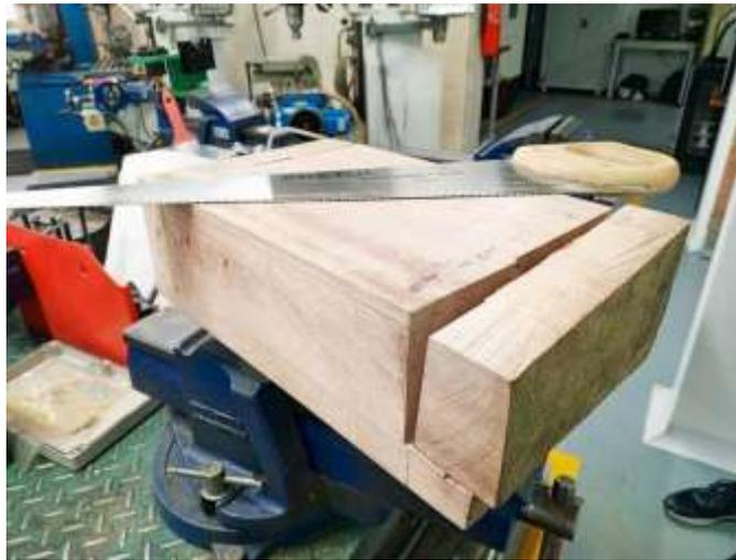
**Nota.** *Imagen del bloque de madera en proceso de preparación para modelamiento CNC.*
