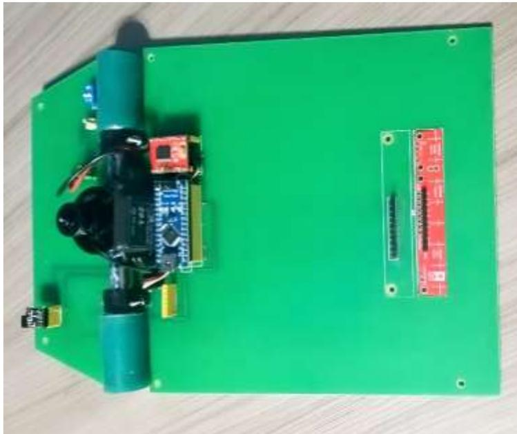
**Nota.** *Imagen de la vista superior del robot velocista ensamblado sin la carrocería aerodinámica.*
