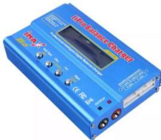
**Nota.** Imagen del cargador baterías LiPo IMAX B6. Tomado de: [ja-bots.com/producto](http://ja-bots.com/producto).
