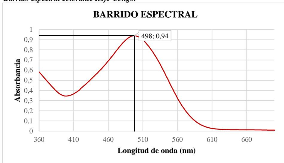
**Nota.** La Figura representa el barrido espectral realizado con una concentración de 15 mg/L de una solución de rojo Congo en un rango de 360 a 660 nm.
