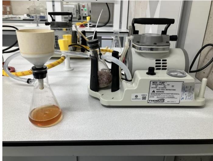
**Nota.** Se observa la separación sólido-líquido filtrando al vacío.
