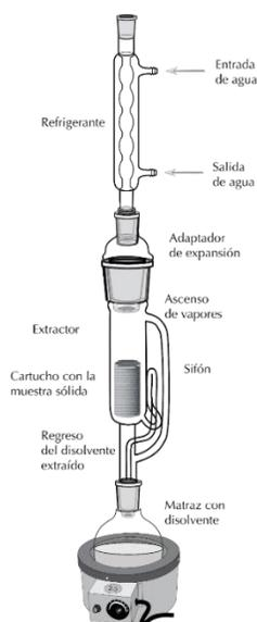
**Nota.** Montaje para la extracción Soxhlet.
