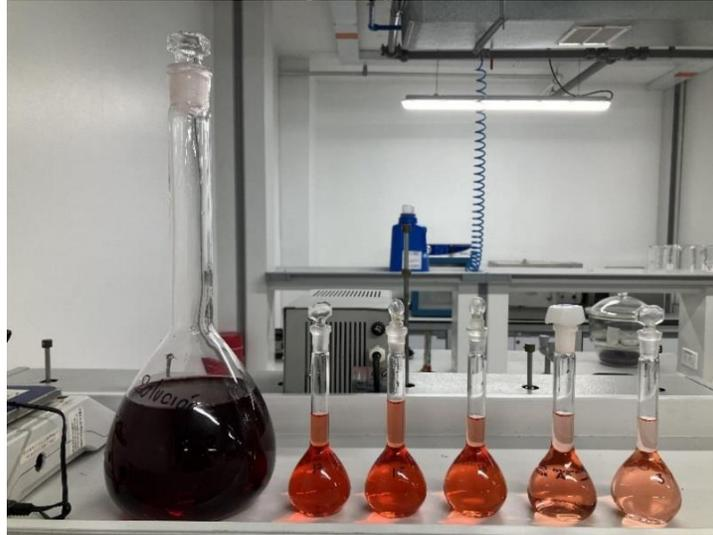
**Nota.** La Figura representa las diluciones realizadas para obtener la curva de calibración, con concentraciones de izquierda a derecha de 100, 17, 15, 10, 5 y 3 mg/L de colorante rojo Congo.
