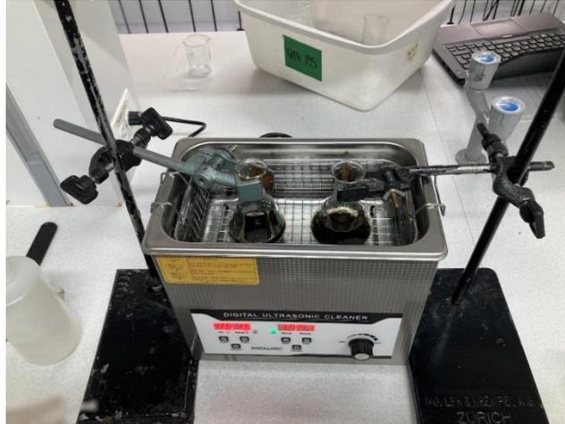
**Nota.** Montaje baño de ultrasonido a 40°C y 15 minutos para los experimentos 2 y 5.
