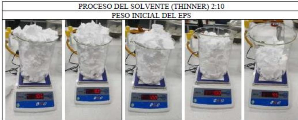
*Nota.* Esta tabla muestra el peso del poliestireno expandido junto al solvente orgánico de thinner en la relación de formulación 2:10 (45 g soluto / 225 g solvente), con esta muestra se cumple con la cantidad requerida para la formulación descrita
