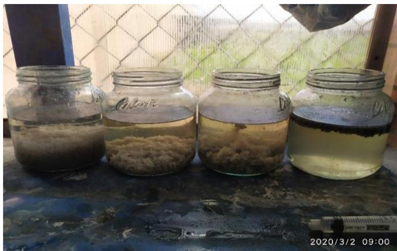
Al finalizar la dosificación en la tolva se detiene la agitación, apagando el tablero eléctrico, se toma una muestra, para saber el resultado final, pH y sedimentación.
