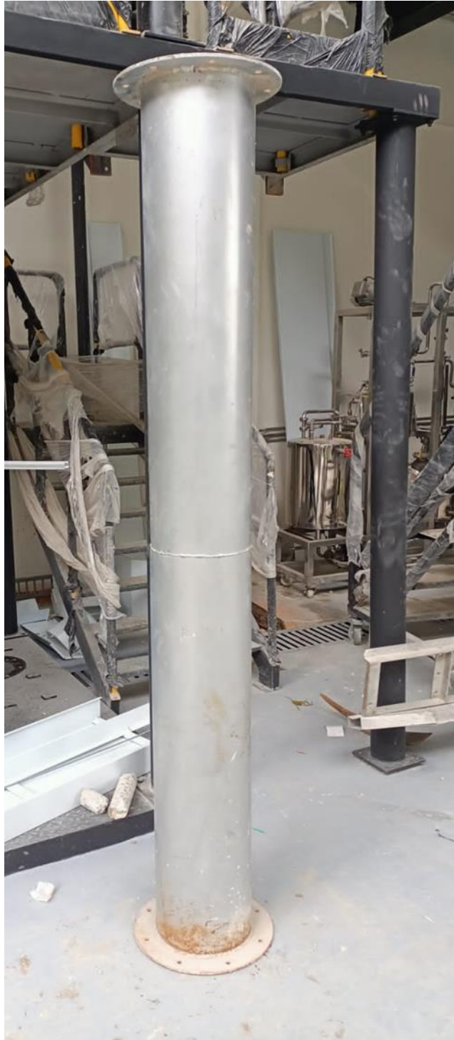
Nota. Módulo torre destilación.
