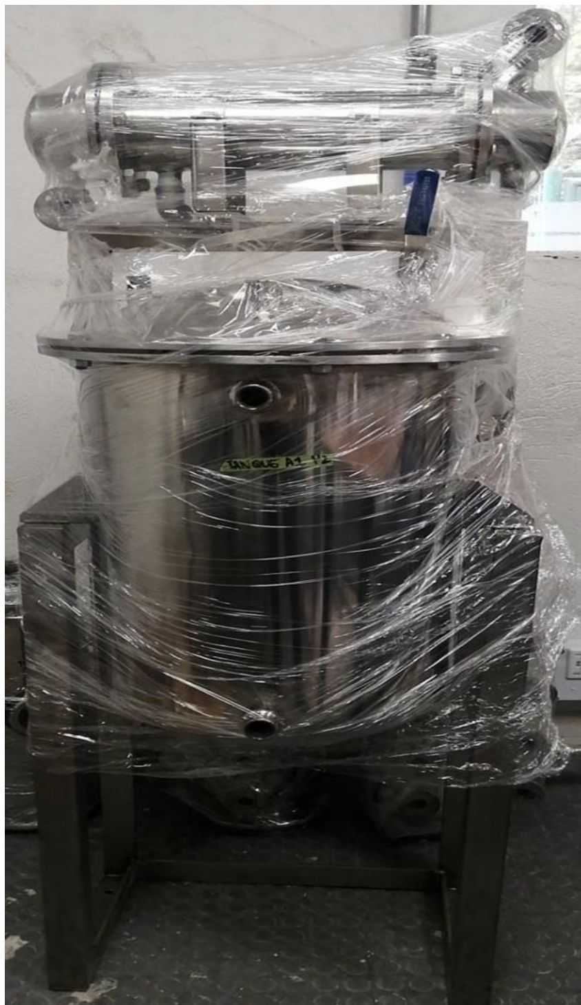
Nota. Tanque A1 P2 – condensador P3
