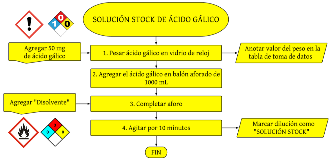
Anexo 3-2. Diagrama de flujo para la preparación de la solución stock
