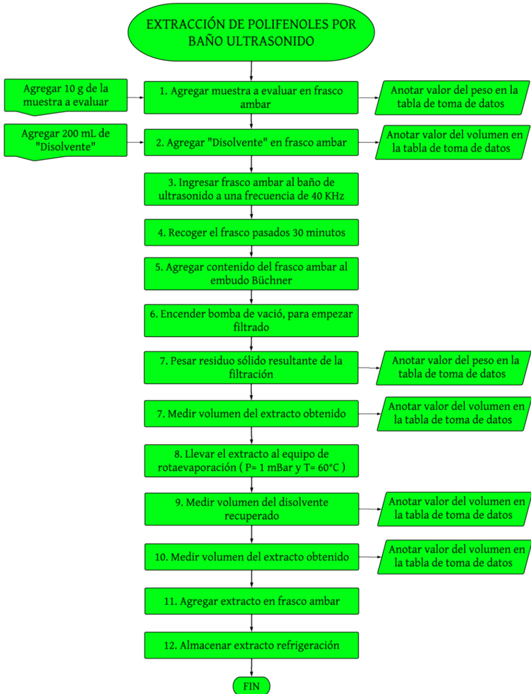
Anexo 5-1. Diagrama de flujo de la extracción por ultrasonido
