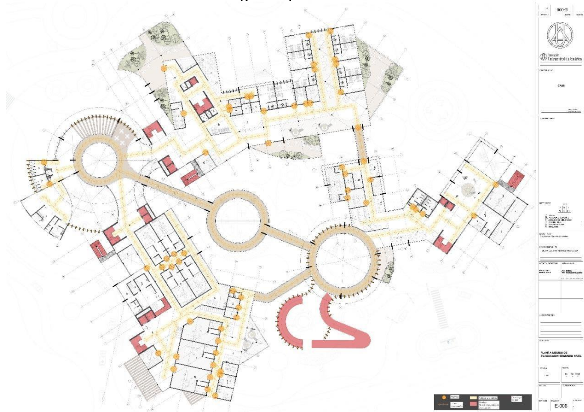
Nota. Planta sistema de evacuación segundo piso
