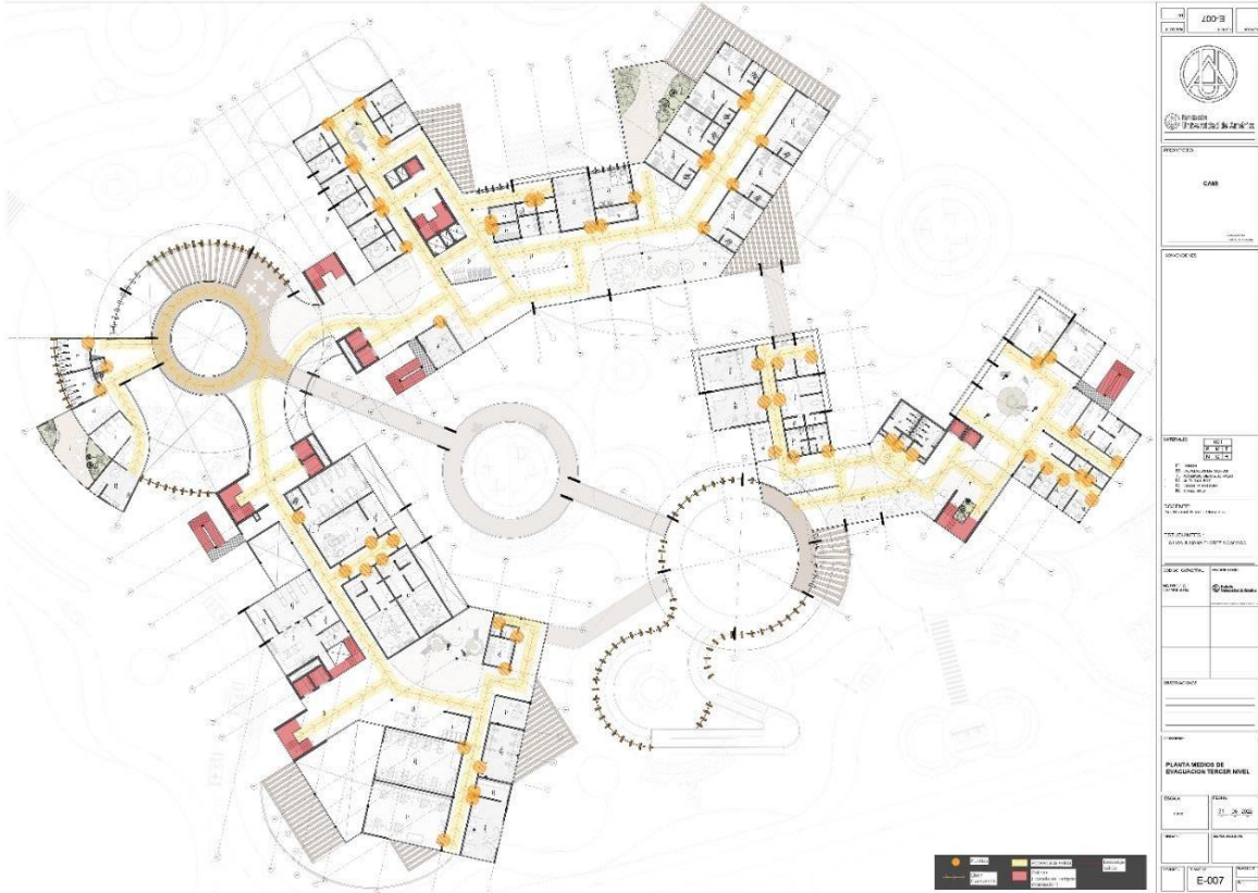
Nota. Planta sistema de evacuación tercer nivel
