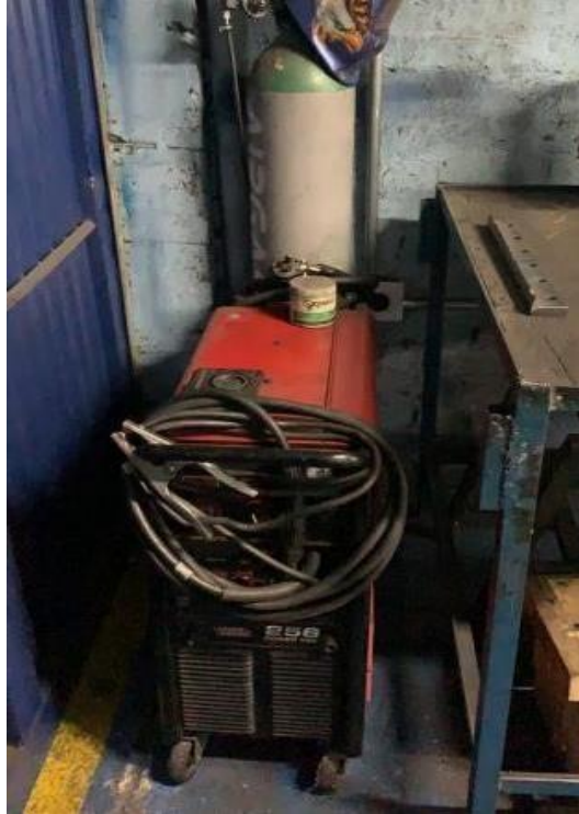
Figura. 7 Equipo de soldadura MIG.
