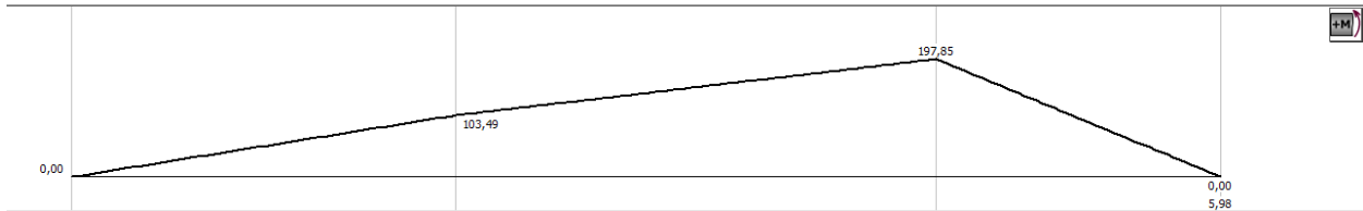
Diagrama de flectores en el eje
